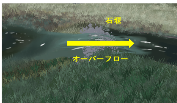
図 3 : 湿地 (遊水地) 捌け口のオーバーフローのイメージ
