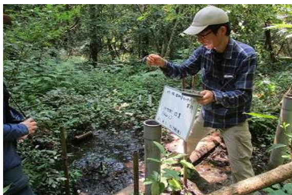
地金堀脇の井戸に水位計を設置
